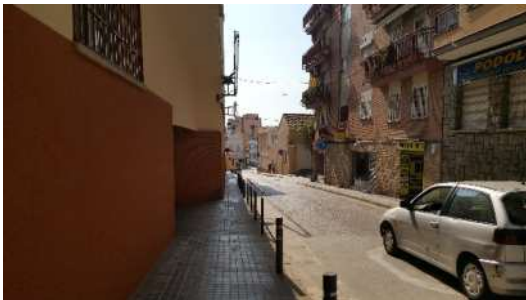
Imatge 12. Desproporció d'espai de calçada i voreres. Un excés d'ample i el pendent incrementa la velocitat amb que arriben els vehicles a la cruïlla amb carrer Fontanills (2017).
