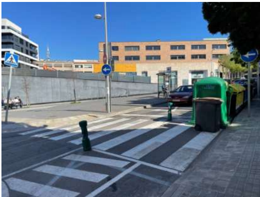
Imatge 3. Contenidors abans de pas, poden destorbar la visibilitat mútua entre vianants i conductors.
