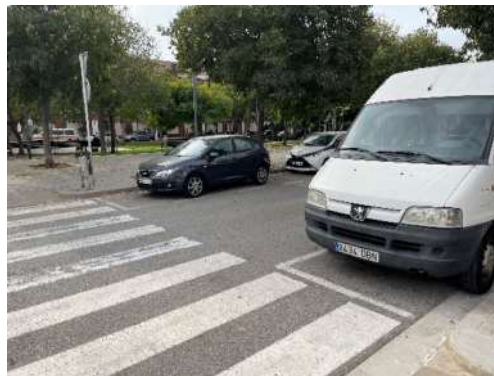
Imatge 103. Greu obstrucció de visibilitat al pas de c. Manila. Itinerari entre zona verda (parc infantil), CAP i llar d'infants.
