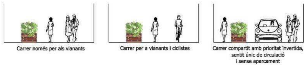
Gràfic 39. Seccions per a carrers amb amplada de 7 a 9 metres
