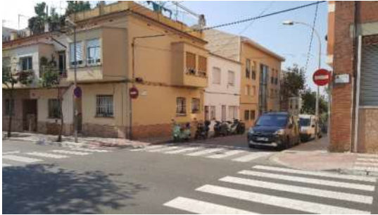
Imatge 63. S'ha posat aparcament de motocicletes a un costat (en filera), però a l'altre el vehicle obstrueix la visibilitat). Només hi ha senyalització d'estop vertical, però existeix línia de detenció. (2017)
