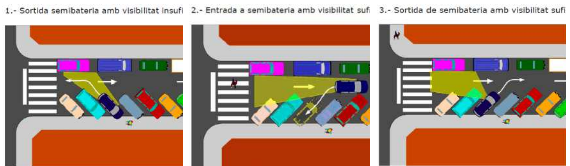
Gràfic 53. Explicació de funcionament de la semibateria inversa
