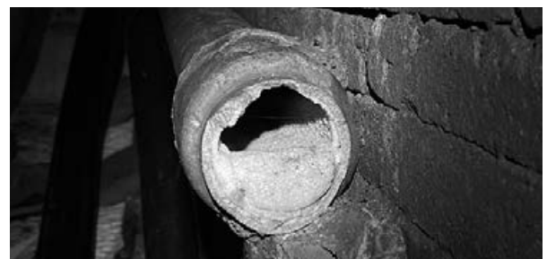
Canonada cilíndrica de ceràmica en la qual es pot veure la tosca que s'ha format a l'interior com a conseqüència de la duresa de l'aigua amb un alt contingut de sals de magnesi i de calci. Foto: Rosa M. Andrés Blanch.
